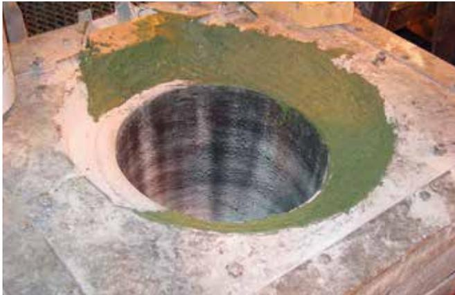
5.7 Calentar el horno con el crisol cargado iniciando con 50 kw (+/- 15% de la capacidad del horno) por 1 hora y subiendo a 50 kw/h hasta 200 kw. Elevar la potencia hasta la potencia de fusión e iniciar el trabajo. Obs.: frecuencia del horno: 1200 hz.
