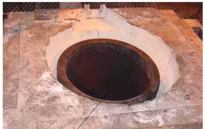
Distancia del borde del crisol para el borde del horno (150 mm).
